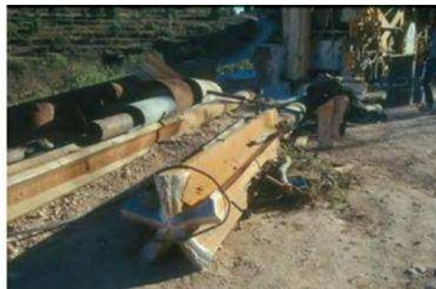
Foto 40. Máquinas de percusión con trépano y válvula.
