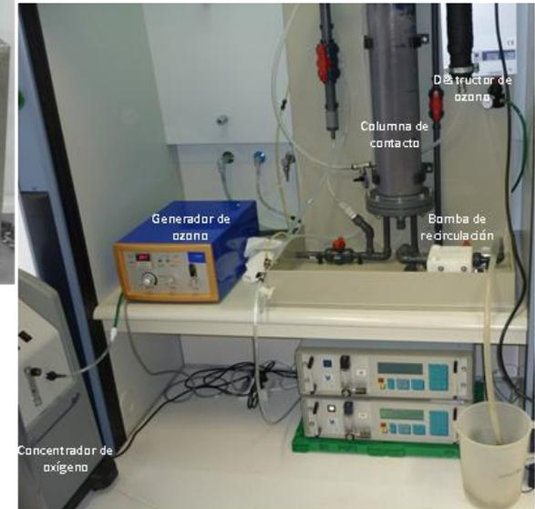
**Ensayos a escala de laboratorio**
