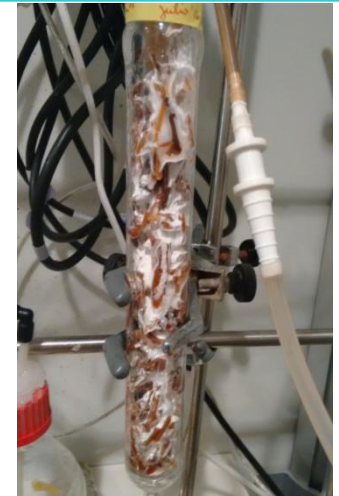
Filtre percolador amb T. versicolor crescut sobre fusta
