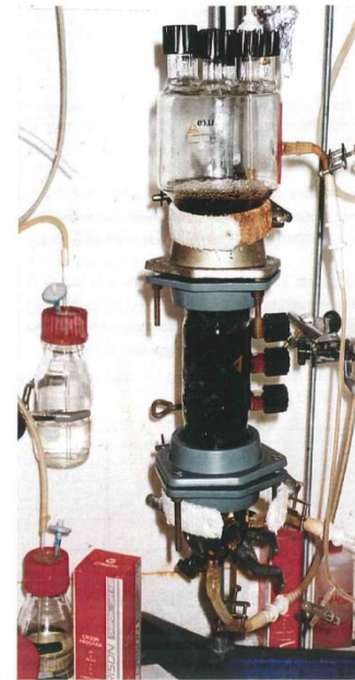
Fotografía 2.6.1: Reactor LIFX amb el fong immobilitzat tractant medi amb lleixius negres.
